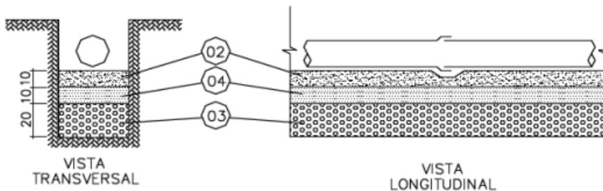
d) EM SOLO QUE NÃO OFERECE CONDIÇÕES MECÂNICAS DE SUPORTE, EM PRESENÇA DE ÁGUA
