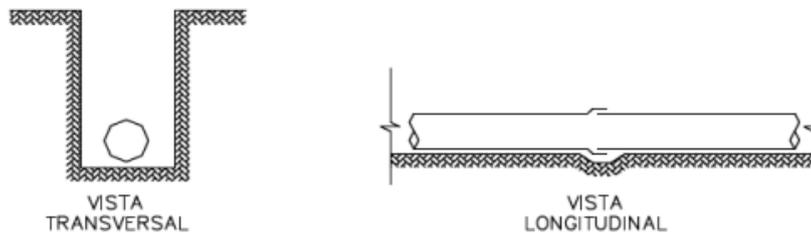
b) NORMAL COM PRESENÇA DE ÁGUA : QUANDO O SOLO OFERECE CONDIÇÕES MECÂNICAS DE SUPORTE , POREM COM PRESENÇA DE ÁGUA
