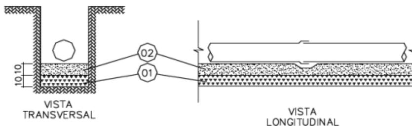
c) EM SOLO QUE NÃO OFERECE CONDIÇÕES MECÂNICAS DE SUPORTE, SEM PRESENÇA DE ÁGUA
