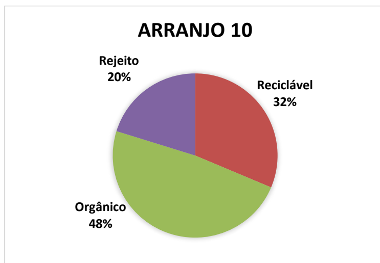
Figura 17 - Composição gravimétrica do arranjo 10
