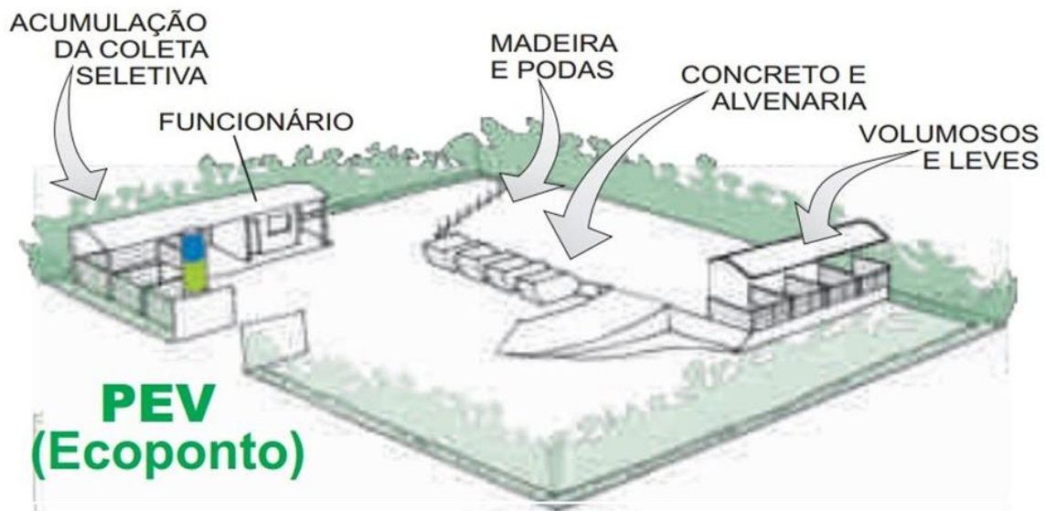
Figura 4 – Layout do modelo de Ecoponto
