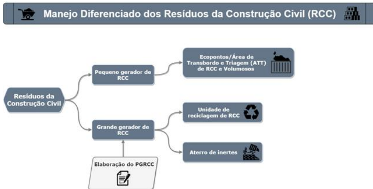
Figura 3 – Fluxograma proposto para o manejo diferenciado dos Resíduos da Construção Civil
