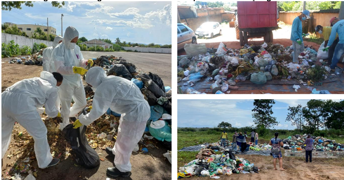
Figura 127 – Triagem dos resíduos sólidos para caracterização gravimétrica
