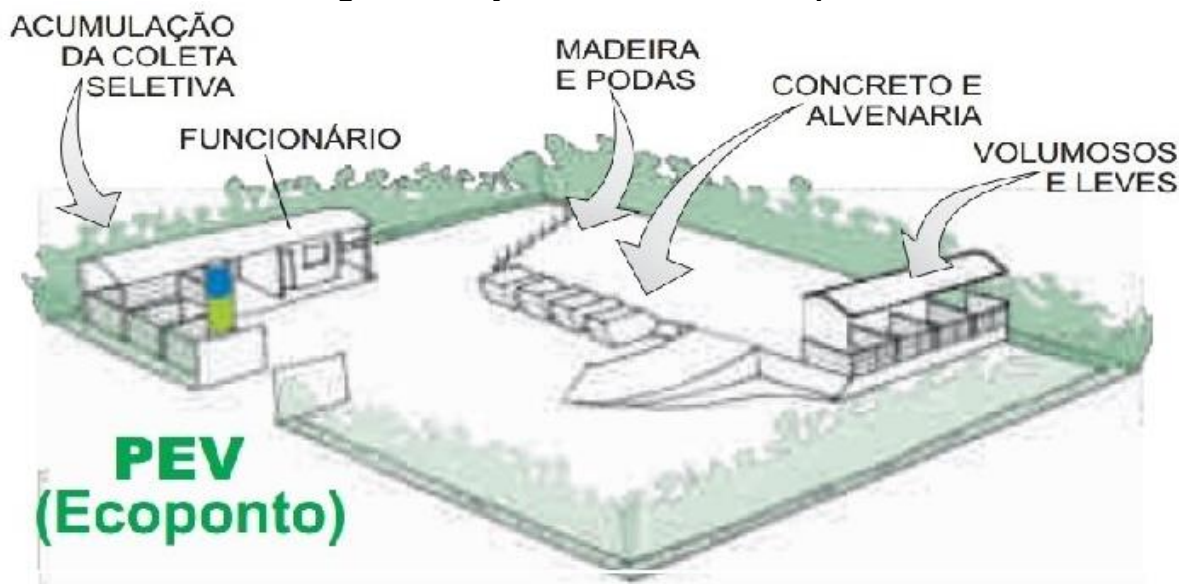
Figura 7 – Layout do modelo de Ecoponto
