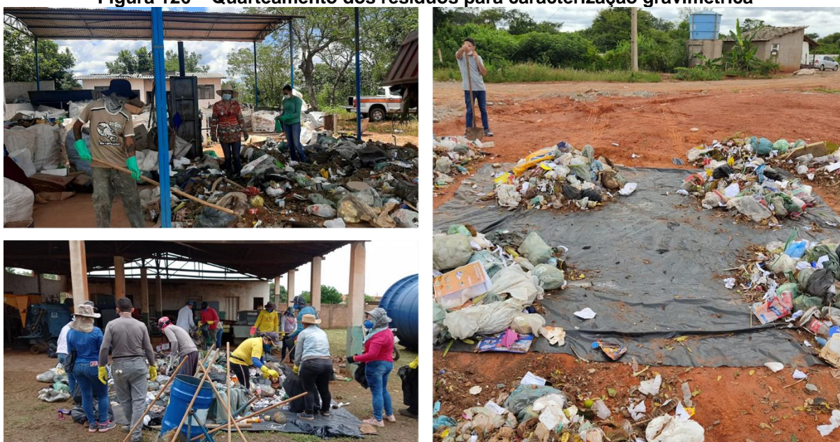
Figura 126 – Quarteamento dos resíduos para caracterização gravimétrica
