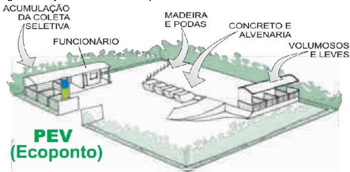
Figura 7 – Layout do modelo de Ecoponto
